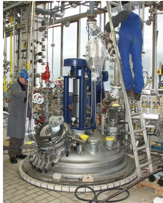
techn. Druck-Rührkessel (Batch-Betrieb)
